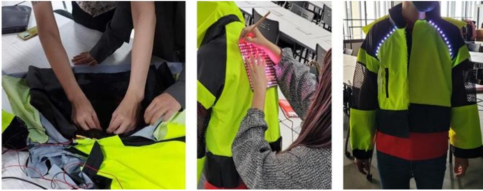
Gambar 13. Proses pemasangan LED dan mikrokontroler pada jaket
